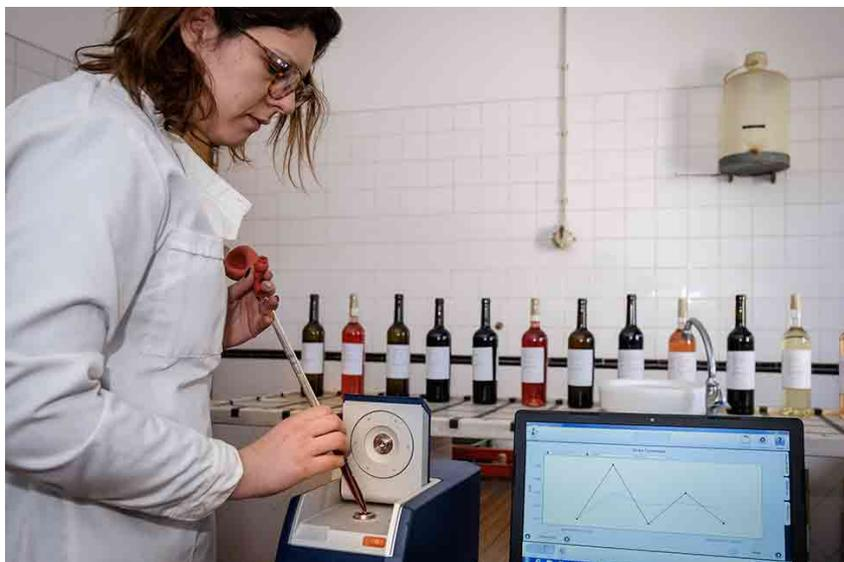
*O Laboratório da CVA está equipado com o analisador Oenofoss, no qual via tecnologia de infravermelhos é possível analisar vários parâmetros físico-químicos, quer do mosto, vinho ou da própria uva. A*
